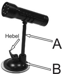
Verbinden Sie die Teile A und B zusammen. Teil B (Saugnapf) kann an jeder glatten und ebenen Oberfläche in beliebigen Neigungswinkel befestigt werden. Legen Sie den Hebel um, damit sich die Montagevorrichtung ansaugt. Verbinden Sie die Kamera mit der Montagevorrichtung.
